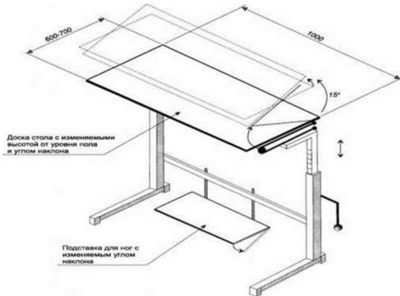
Рисунок 1 – Пример оснащения рабочего места участника с нарушением ОДА (трансформируемый рабочий стол)
